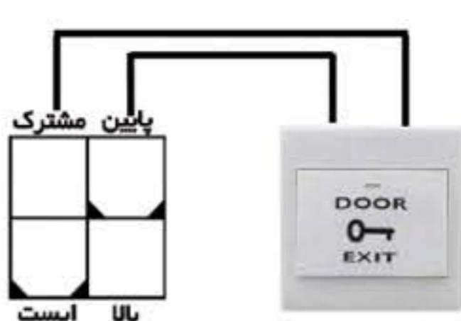
اگر مدار در حالت CH-5 باشد، جهت اتصال شستی، از دو پایه،
