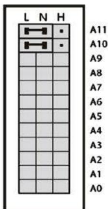
طریقه قرارگیری جامپرها در GAP/FIREWALL/MAGNET FIREWALL:
